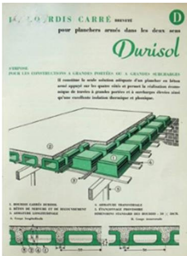
Figuur 19: Durisol vloeren pottensysteem – recente foto's (Erfgoedstudio en arch. Joost Beke) en oude technische fiche (Bron: VAN DE VOORDE, S. (2015), Naoorlogse bouwmaterialen in woningen in Brussel 1945-1975, VUB)
