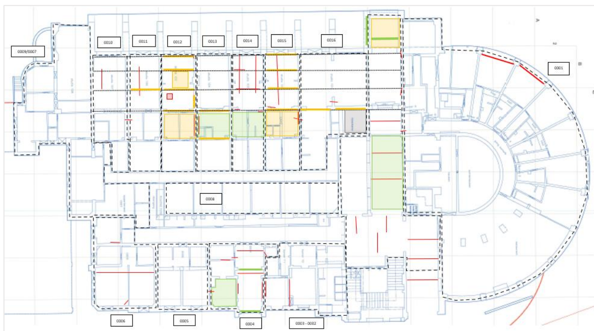
Figuur 83: Geregistreerde schadebeelden interieur gelijkvloers – vloeropbouw 1 ste verdieping (Erfgoedstudio)
