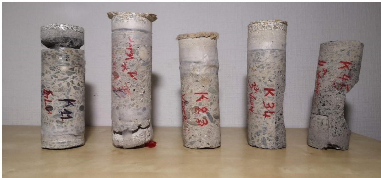
Figuur 32: Foto kernboringen met v.l.n.r. vloeropbouw gelijkvloers, 2 de verdieping, 3 de verdieping, 4 de verdieping en dak (Erfgoedstudio)
