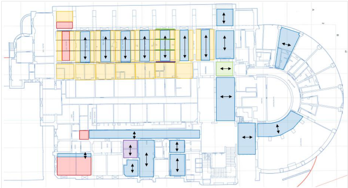
Figuur 25: Gewelftypes gelijkvloers – vloeropbouw 1 ste verdieping (Erfgoedstudio)
