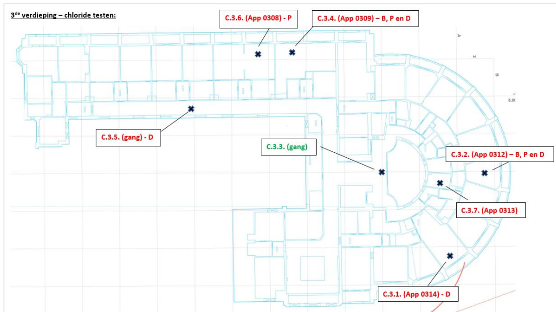
Figuur 86: Locaties meetpunten chloridetesten op 3 de verdieping (Erfgoedstudio)
