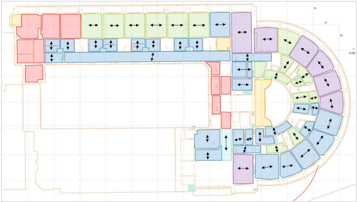
Figuur 21: Gewelftypes 4 de verdieping – opbouw dakstructuur (Erfgoedstudio)
