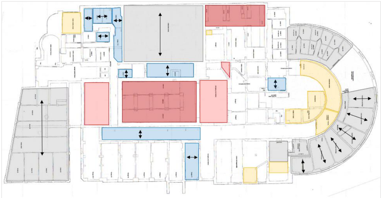
Figuur 26: Gewelftypes kelder verdieping – vloeropbouw gelijkvloers (Erfgoedstudio)
