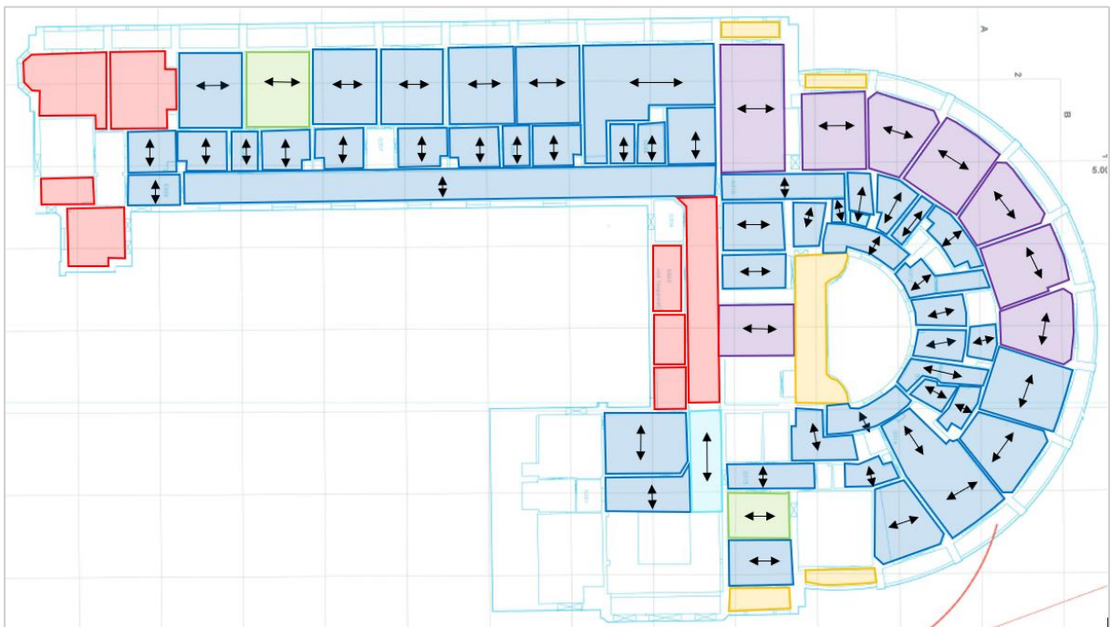
Figuur 22: Gewelftypes 3 de verdieping – vloeropbouw 4 de verdieping (Erfgoedstudio)
