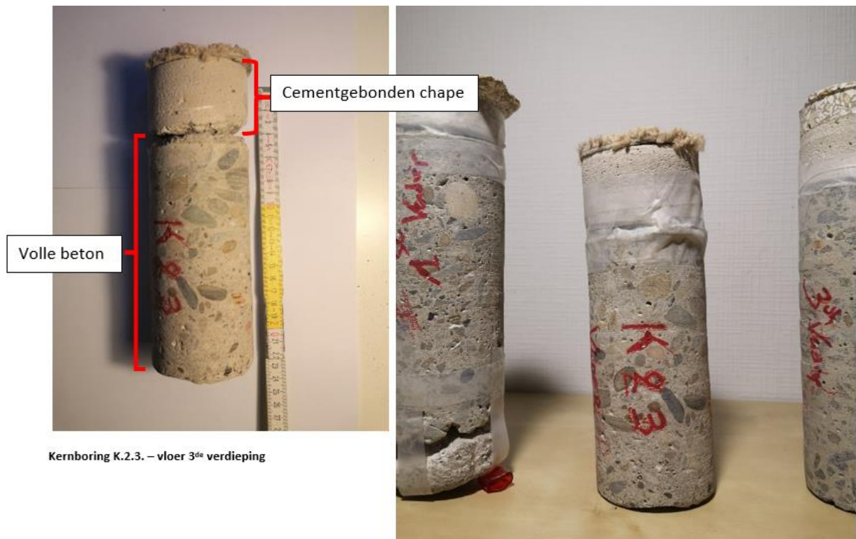
Figuur 35: Details van kernboring K.2.3 – vloer 3 de verdieping (Erfgoedstudio)
