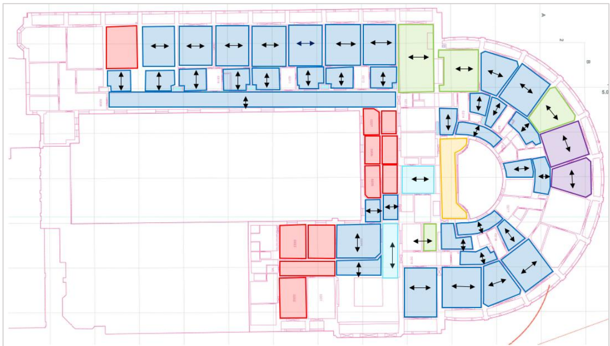
Figuur 23: Gewelftypes 2 de verdieping – vloeropbouw 3 de verdieping (Erfgoedstudio)
