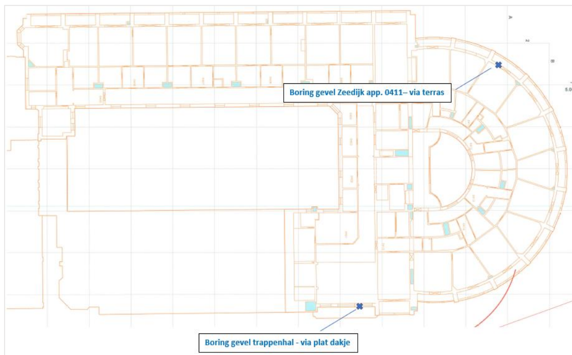
Figuur 99: Locatie kernboringen gevelwand 4 de verdieping (Erfgoedstudio)
