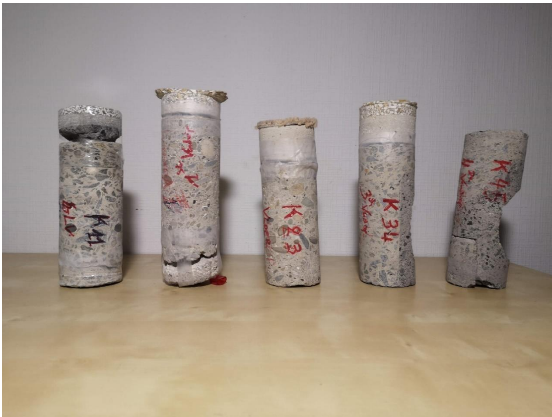
Foto boringen v.l.n.r. vloeropbouw gelijkvloers, 2 de verdieping, 3 de verdieping, 4 de verdieping en dak
